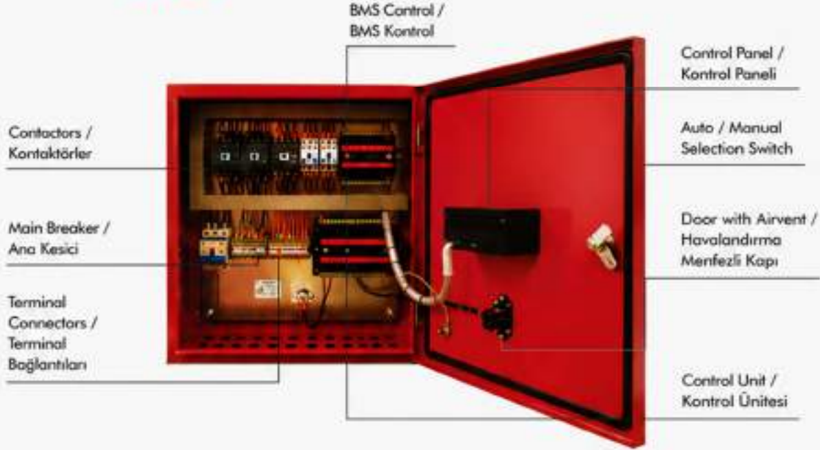
Figure 6: NFPA 20 Electrical Front Panel Interior View Şekil 6: NFPA 20 Elektrikli Yangın Pompa İç Görünüm
